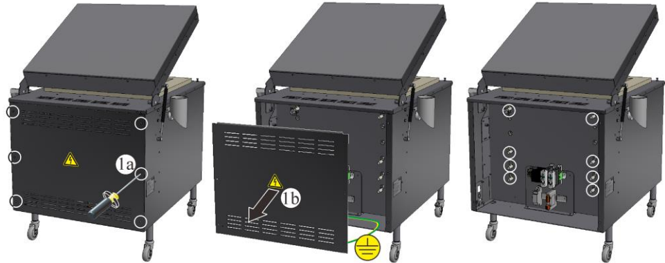
Kuva 75: Sähkökaapin katteen purkaminen uunin takasivulta (kuva viitteellinen)
