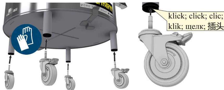
Kuva 15: Siirtopyörien asennus (kuva viitteellinen)
