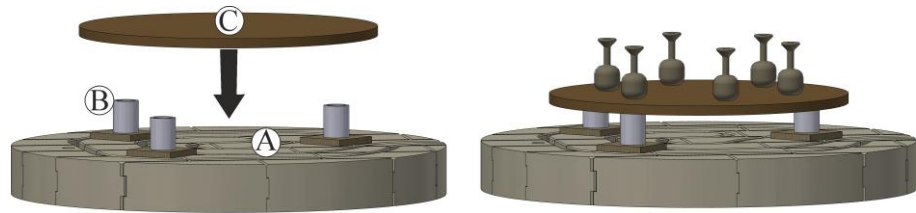
Kuva 41: Asennuslaatan (C) asettaminen asennustukien päälle (kuva viitteellinen)
