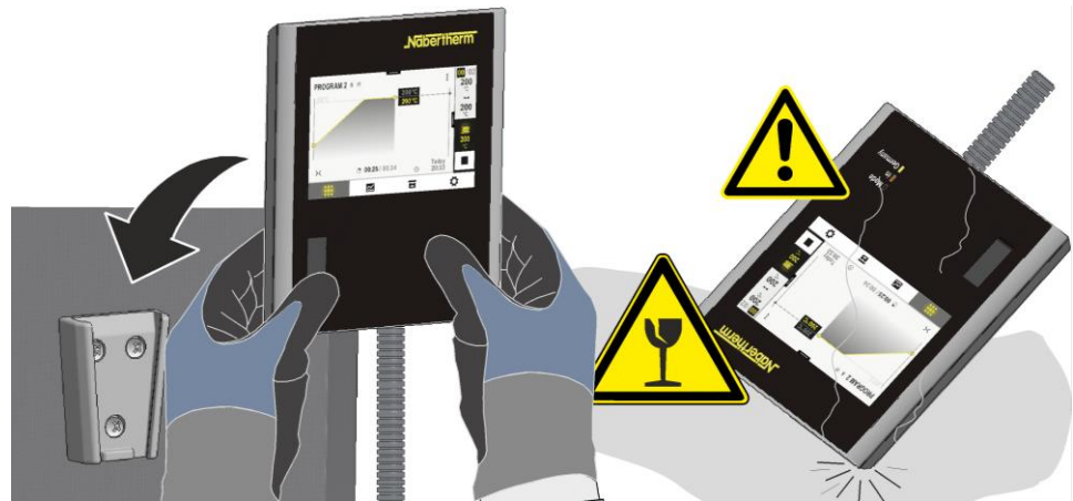
Kuva 33: Controllerin asettaminen uunin kyljessä olevaan pidikkeeseen (kuva on viitteellinen)
