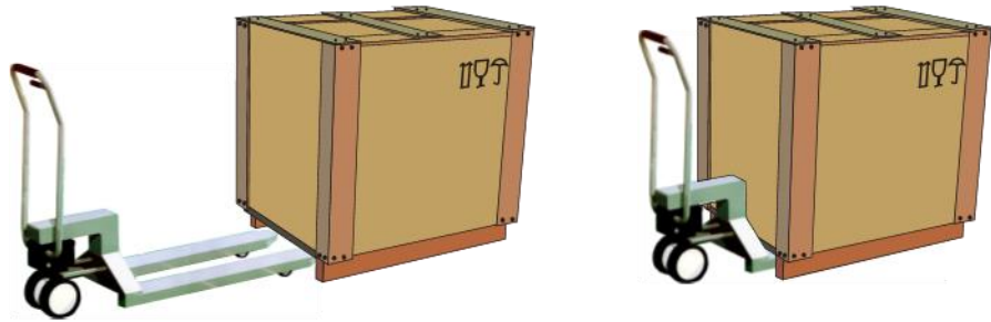
Kuva 10: Nostovaunu työnnetään täysin kuljetustelineen alle
