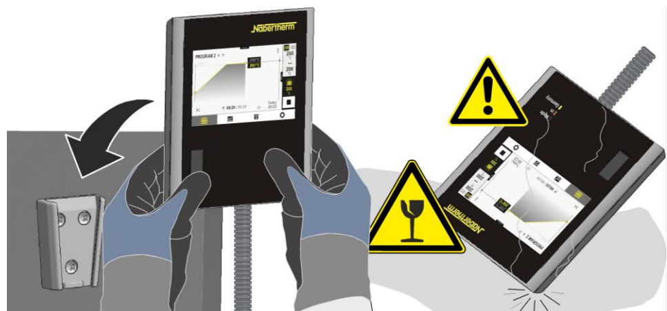
Kuva 21: Controllerin asettaminen uunin kyljessä olevaan pidikkeeseen (kuva on viitteellinen)
