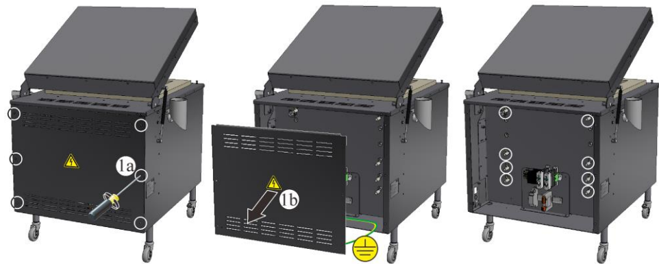
Fig. 75: Afmonter tavleanlæggets afdækning på ovnens bagside (eksempelbillede)
