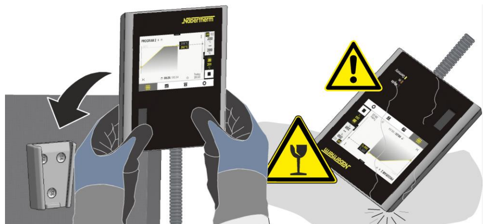
Fig. 21: Sæt controlleren ind i den på ovnen anbragte holder (eksempelbillede)
