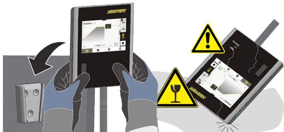
Fig. 33: Sæt controlleren ind i den på ovenn anbragte holder (eksempelbillede)
