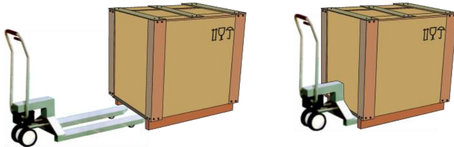
Fig. 10: O porta-paletes é inserido por completo por baixo da armação de transporte
