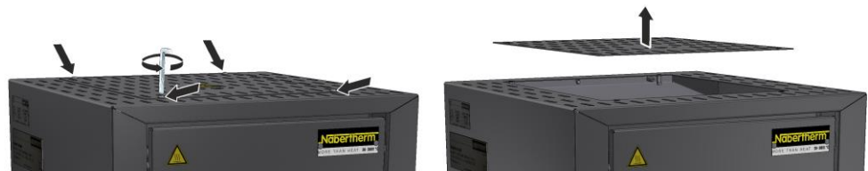
44. ábra: A burkolat leszerelése – LHT 01/17 D modell (az ábrához hasonlóan)
