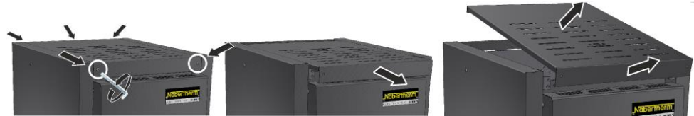
56. ábra: A burkolat leszerelése – LHT 03/17 D modell (az ábrához hasonlóan)
