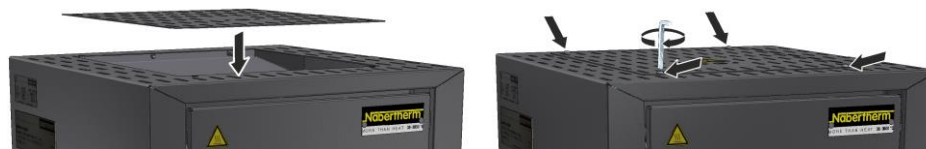
39. ábra: A burkolat felszerelése – LHT 01/17 D modell (az ábrához hasonlóan)
