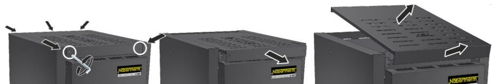
45. ábra: A burkolat leszerelése – LHT 03/17 D modell (az ábrához hasonlóan)
