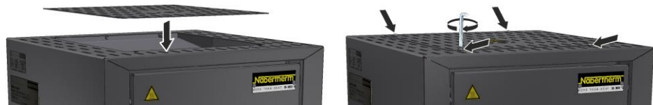
19. ábra: A burkolat felszerelése – LHT 01/17 D modell (az ábrához hasonlóan)
