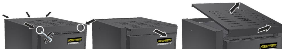
37. ábra: A burkolat leszerelése – LHT 03/17 D modell (az ábrához hasonlóan)
