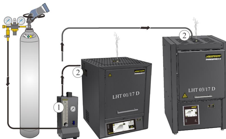
64. ábra: Csatlakoztatás a gázosító rendszerhez (az ábrához hasonlóan)
