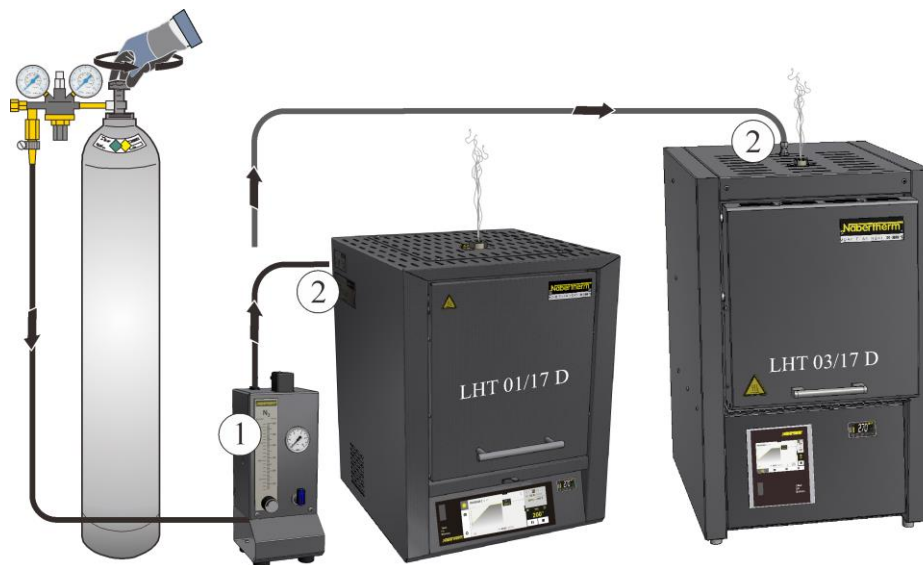
Εικ. 64: Σύνδεση στο σύστημα παροχής αερίου (παρόμοια με την εικόνα)
