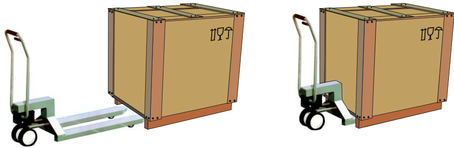
Εικ. 12: Το ανυψωτικό όχημα έχει τοποθετηθεί ολόκληρο κάτω από το πλαίσιο μεταφοράς
