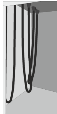
Εικ. 24: Παράδειγμα: Παραμόρφωση των θερμαντικών στοιχείων που αποτελούνται από διπυριτιούχο μολυβδαίνιο (παρόμοια με την εικόνα)
