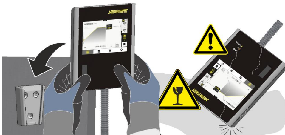
Slika 55: Vstavev krmilnika v držalo na peči (podobno kot na sliki)
