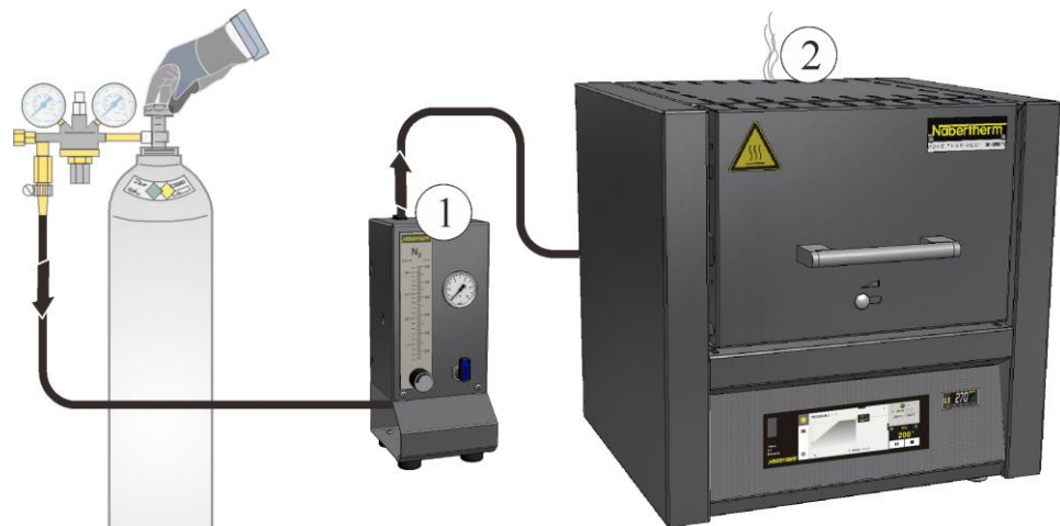
Bild 50: Anslutning till gasningssystemet (liknar den på bilden)
