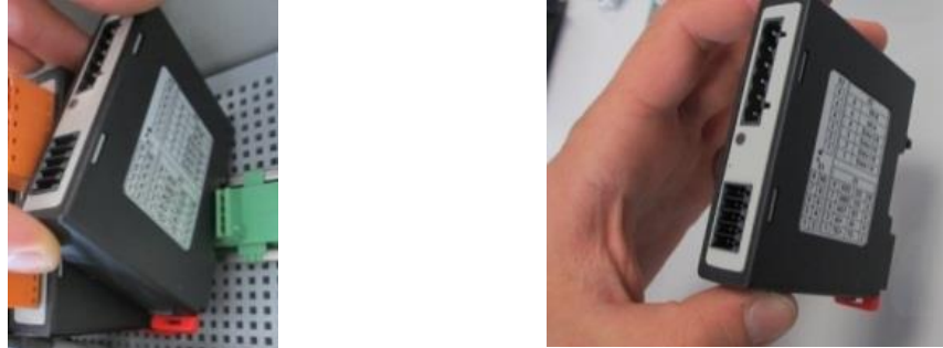
Resim 10: Regülatör modülünün sökülmesi – Bölüm 2 (resme benzer)
