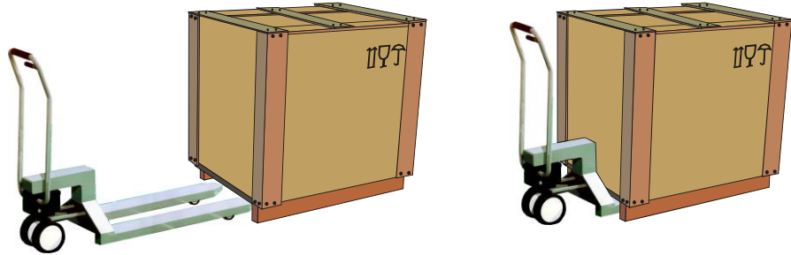
Şekil 14: Forklift tamamen taşıma çerçevesinin altına itilir
