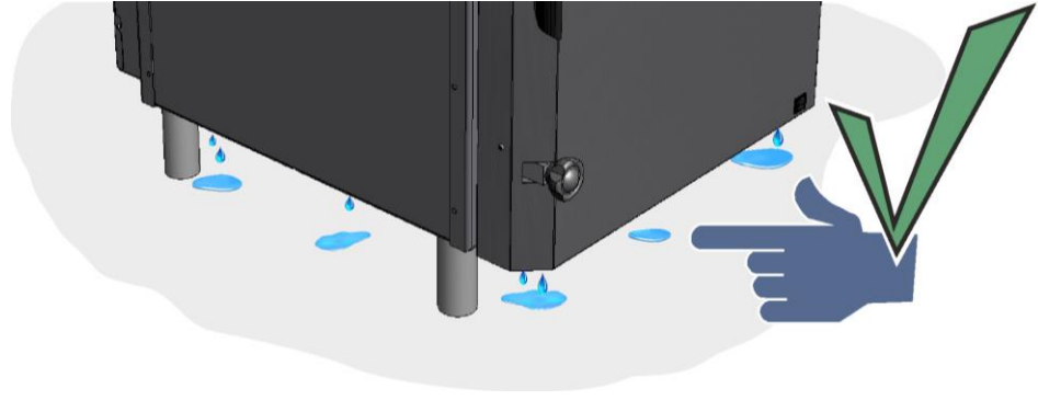
Şekil 67: İlk pişirimler sırasındaki yoğuşma birikintileri (temsili resim)
