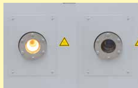
Verre d'inspection refroidi en verre saphir (gauche à température de travail, droite à température ambiante)
