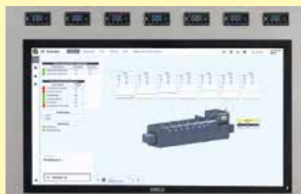
Affichage de toutes les valeurs réglables via le NCC (par exemple, surveillance de la température pour les zones de chauffage, débits de gaz)
