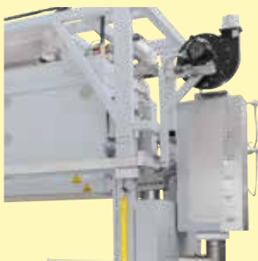
Postcombustion catalytique intégrée à la carcasse du four pour gagner de la place
