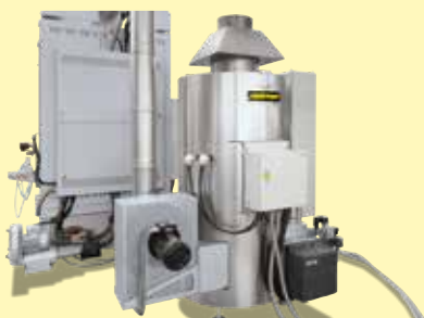
Postcombustion catalytique ou thermique disponible en option (la figure montre la postcombustion thermique)
