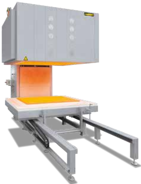
Four à sole élévatrice H 1600/S pour le traitement thermique du verre de quartz. Le four est conçu pour pouvoir être ouvert à 1000 °C. La table peut être retirée pour le traitement des composants.
