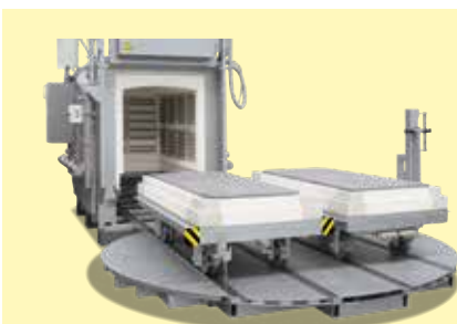
Plateau tournant pour le changement de sole mobile devant le four
