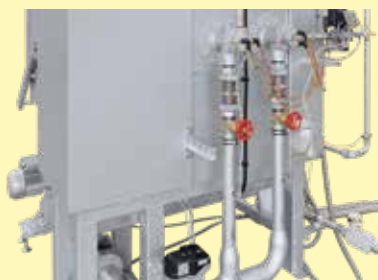
Tirage au gaz avec deux brûleurs dans la paroi arrière du four
