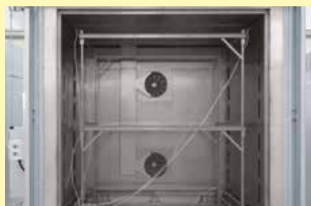
Cadre de cartographie adapté pour four chambre à circulation d'air N 7920/45 HAS
