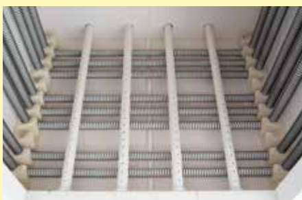
Tuyaux d'aération assurant un apport d'air frais homogène lors du déliantage
