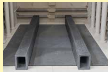
Support de charge SiC pour faciliter le chargement/déchargement au moyen d'un chariot élévateur
