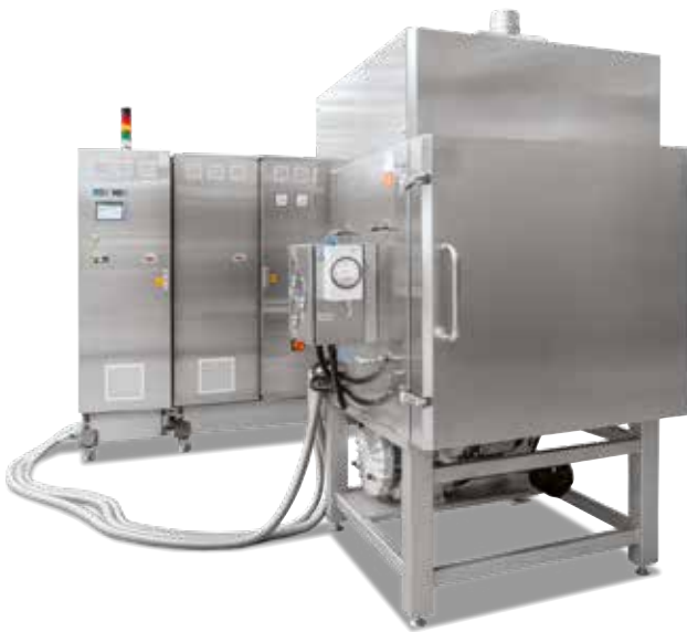
Four chambre à convection forcée NACS 250/65 DB200-3 pour les applications de déliantage modèle salle blanche
