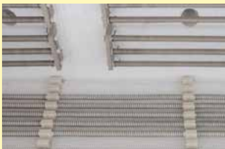
Isolation en fibres pour réduire les temps de chauffage et de refroidissement
