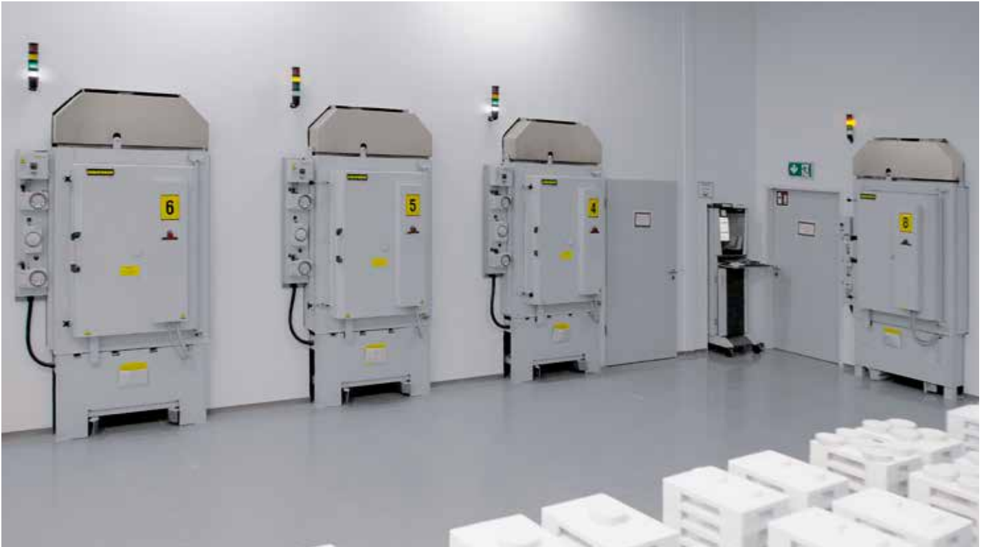
Fours chambre combinés N 650 DB 200-3 pour le déliantage et le frittage en salle blanche/salle grise
