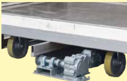
Sole sur roues en métal entraînée par crémaillère sans pose de rails
