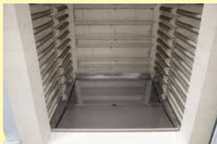
Cuve d'évacuation dans le fond
