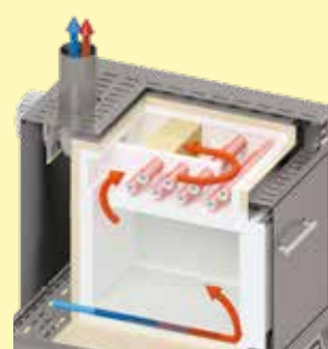
Schéma de principe du flux d'air dans le four d'incinération L 24/11 BO
