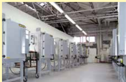
Fours chambre N 200/14 pour le frittage de semi-conducteurs
