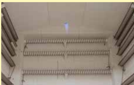
Chambre du four N 300 BO avec veilleuse à gaz et chauffage électrique du four
