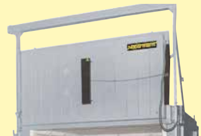
Porte guillotine à entraînement électrohydraulique
