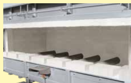
Énergie gaz indirecte à tubes de radiation
