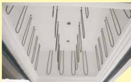
Chauffage de toutes les faces et entre la pile pour optimiser l'homogénéité de températures
