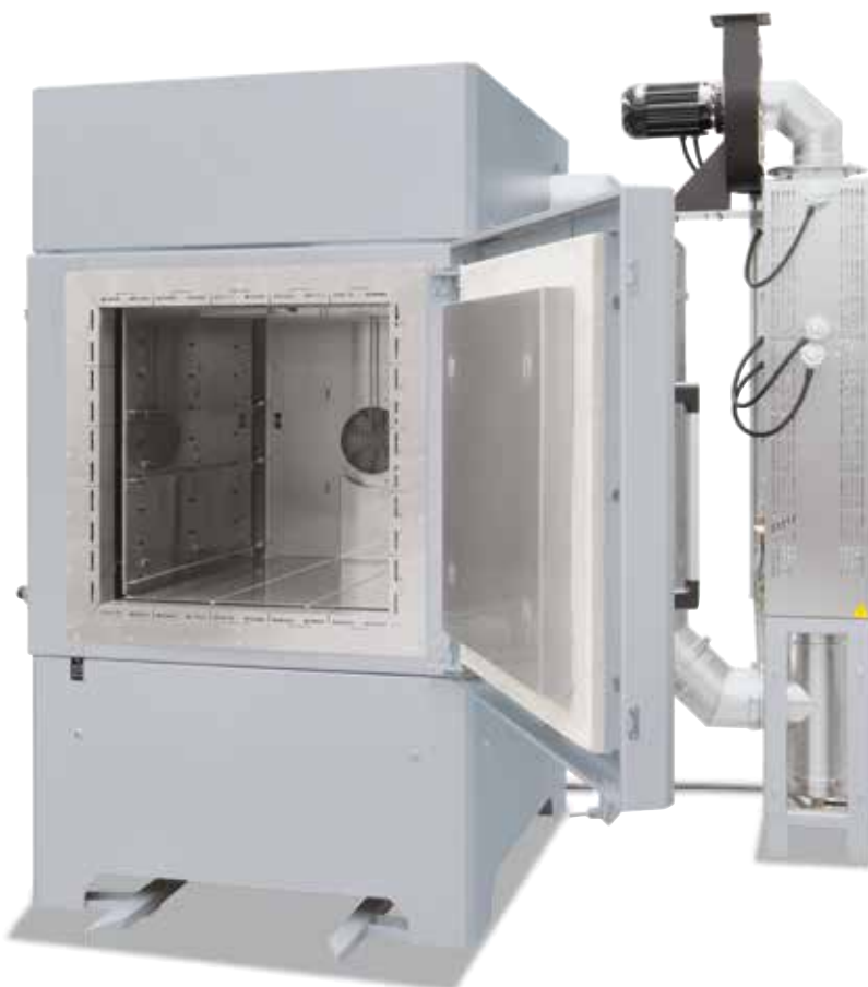
Four chambre à convection forcée NA 500/65 DB200 avec installation de postcombustion catalytique
