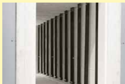
Eléments chauffants SiC installés sur les deux côtés longitudinaux du four à sole mobile
