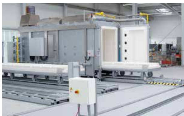
Four à sole mobile énergie gaz WB 6200/12 BO pour la calcination de matériaux céramiques isolants
