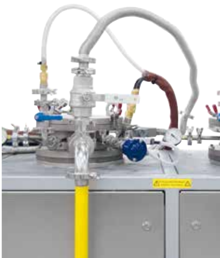
Storte intercambiabili con condotte di alimentazione e misurazione
