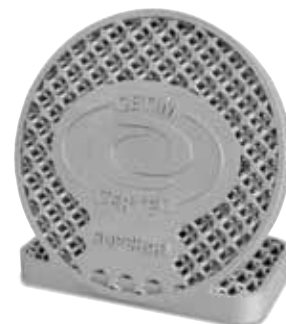
Componente stampato in alluminio, sottoposto a trattamento termico nel modello N 250/85 HA (fabbricante CETIM CERTEC su piattaforma SUPCHAD)
