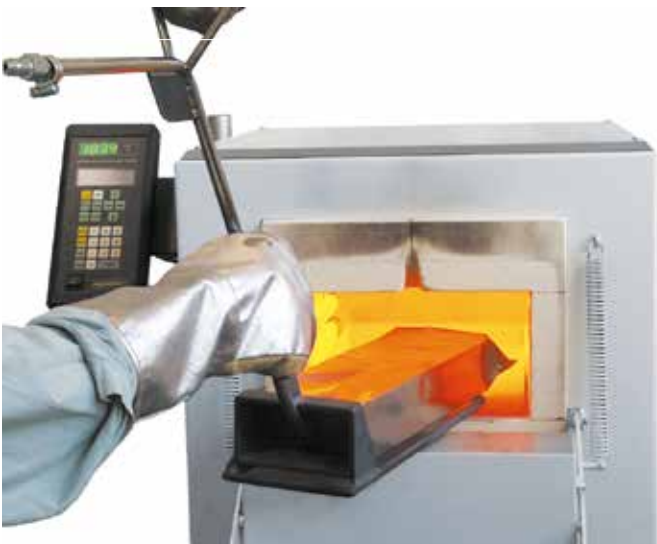
Vassoio con tubo di immissione del gas e con sacchetto di ricottura
