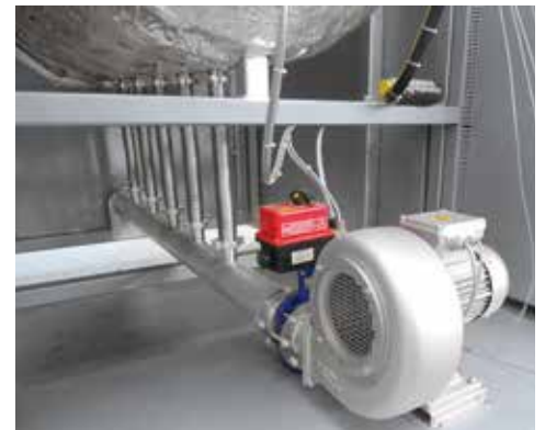
Raffreddamento a ventola forno a storte a pareti calde NRA 400/03
