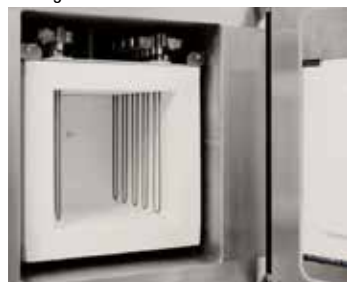
Riscaldatore in disilicuro di molibdeno e isolamento in fibra
