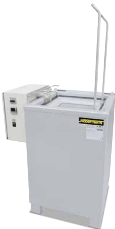
Bagno di raffreddamento Q 200 per raffreddamento in olio e acqua
