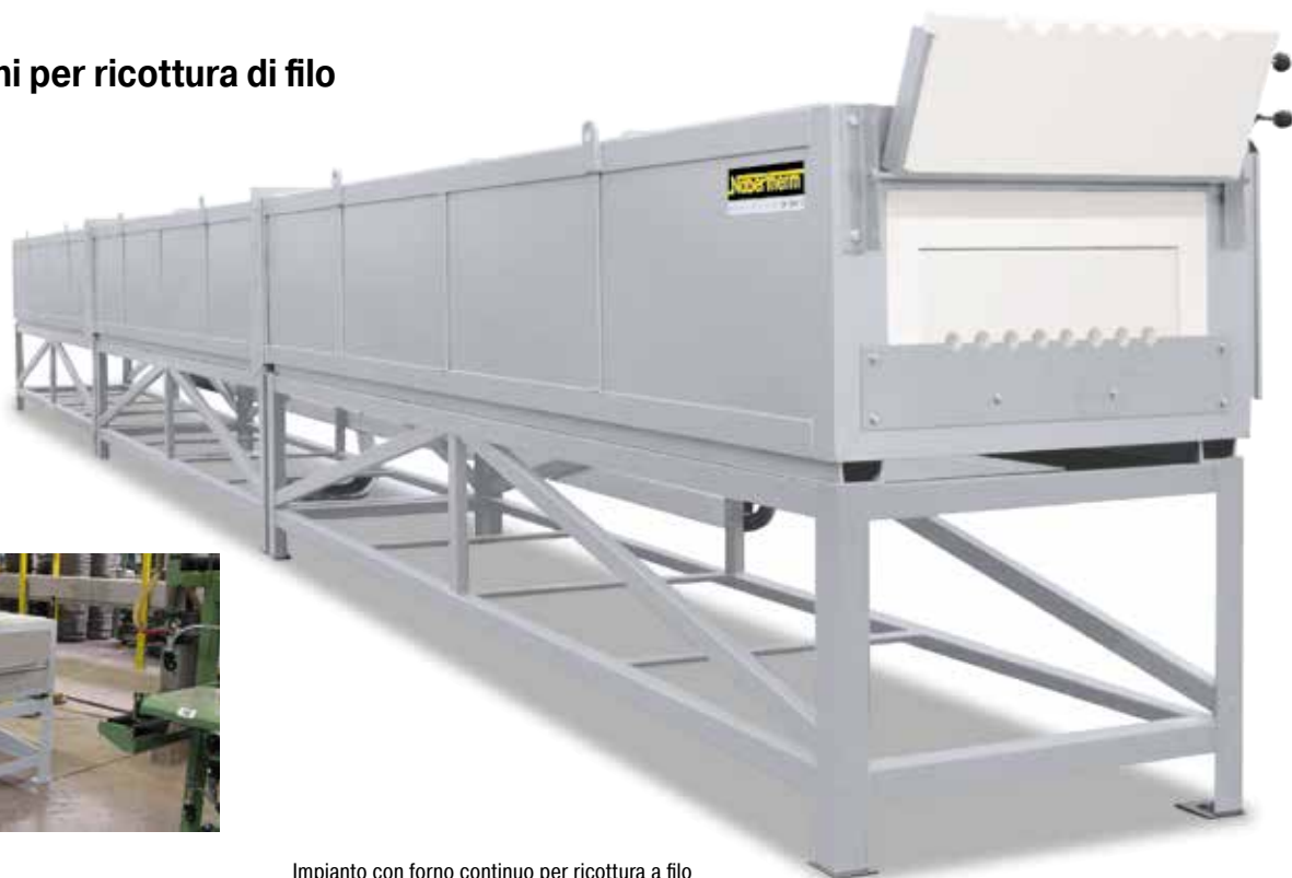
Impianto con forno continuo per ricottura a filo D 390/S
