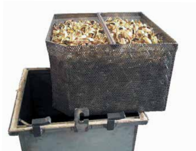
Ricottura in bianco di materiale sfuso all'interno di una cassetta di ricottura con cesto di estrazione
