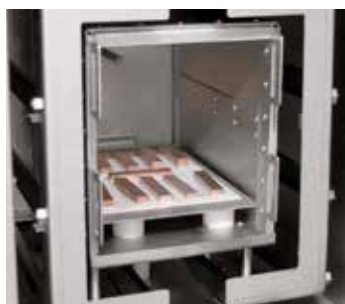
Trattamento termico di barrette di rame con idrogeno in forno a storta VHT 8/16-MO
