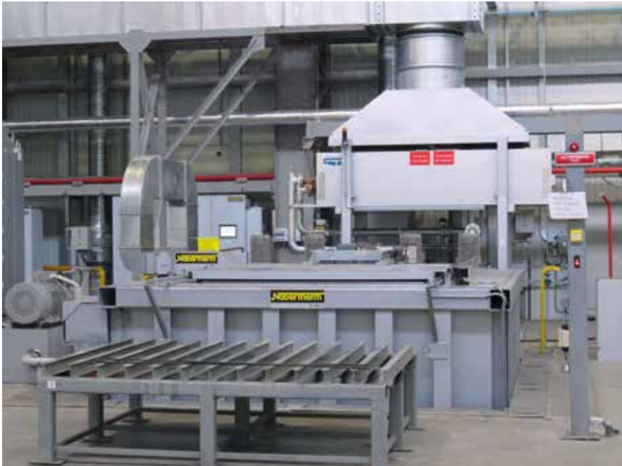
Bagno di raffreddamento a olio OAB 67000 con scambiatore di calore con una capacità di 67.000 litri di olio
