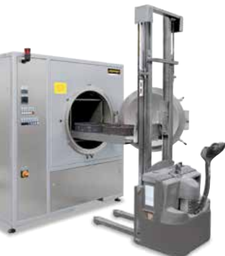
Caricamento del forno a storta NRA 300/06 mediante carrello elevatore
