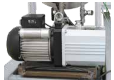
Pompa per vuoto per evacuazione a freddo della storta
