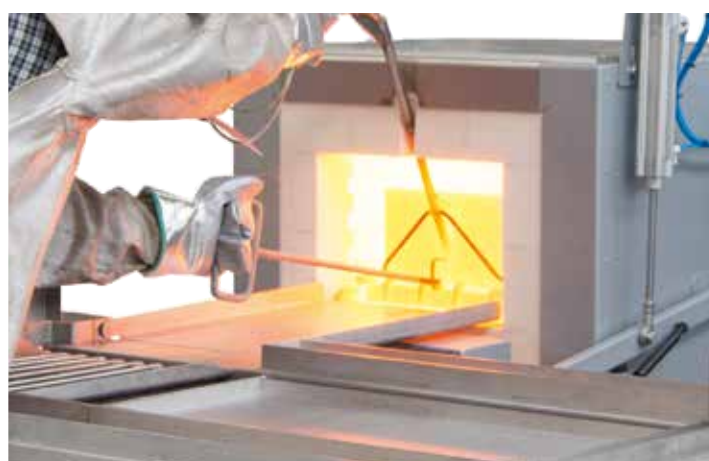
Sistema di tempra sotto gas inerte con forno N 41/H
