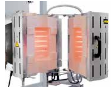
RS 100/250/11S in versione apribile, installabile in un'attrezzatura di prova
