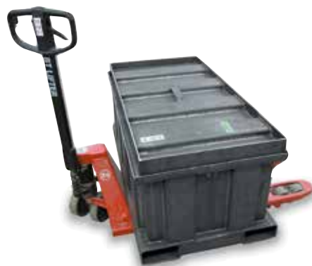
Cassetta di ricottura su carrello elevatore
