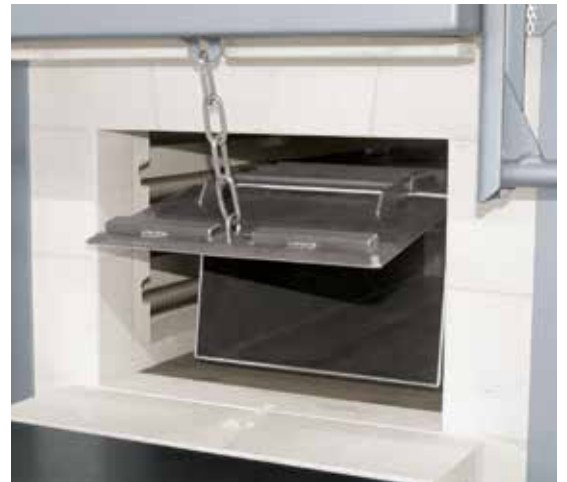
Cassetta di ricottura con flap che si apre insieme alla porta del forno
