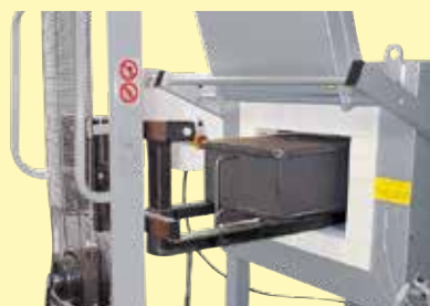
Lavoro con cassetta di cottura per l'atmosfera gassosa protettivi mediante l'ausilio di un carrello di carico
