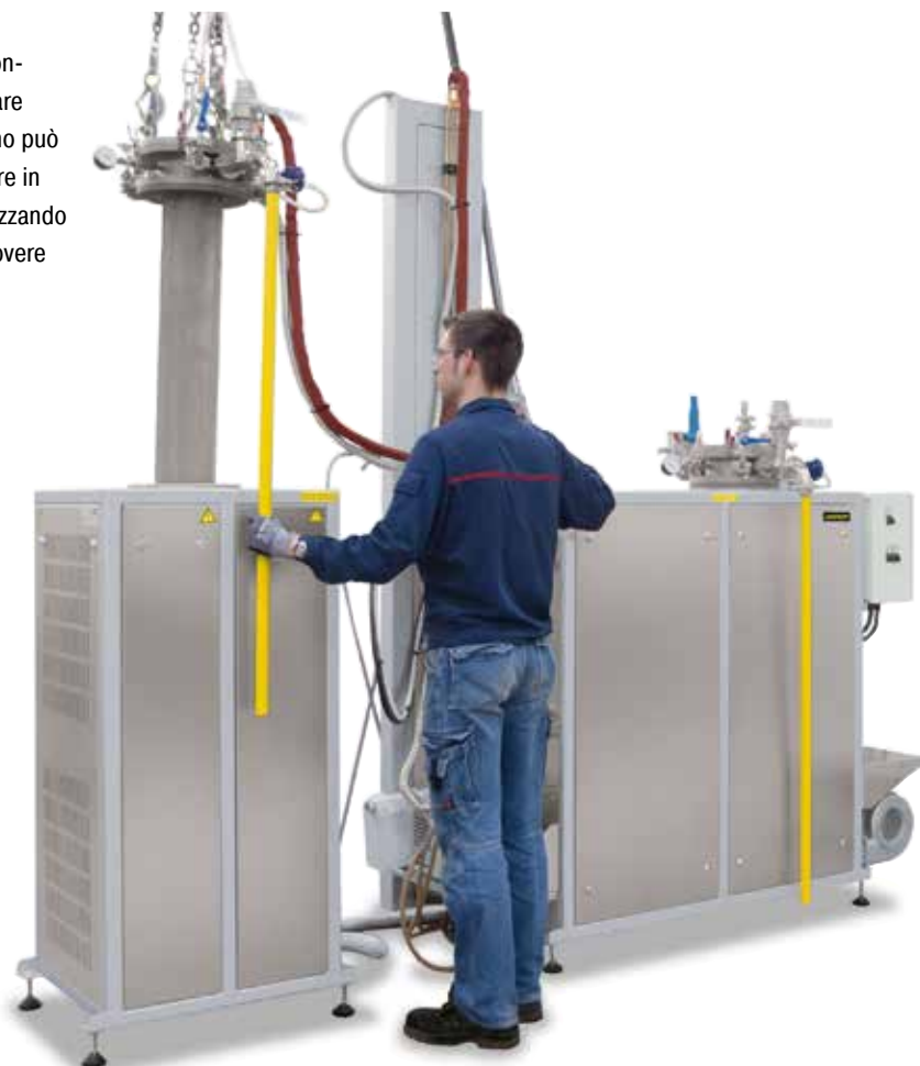
Forno a storte SR 170/1000/11 con storta variabile e stazione di raffreddamento
