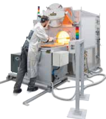
Impianto di bonifica semiautomatico con forno a storte NR 50/11 e bagno di raffreddamento ad acqua su un sistema a rotaie
