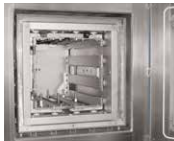
Camera di riscaldamento in molibdeno o in tungsteno
