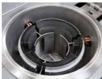
Storta cilindrica con riscaldamento al tungsteno
