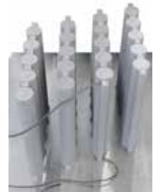
Tiranti in titanio dopo il trattamento termico nel NR 50/11 in atmosfera di argon
