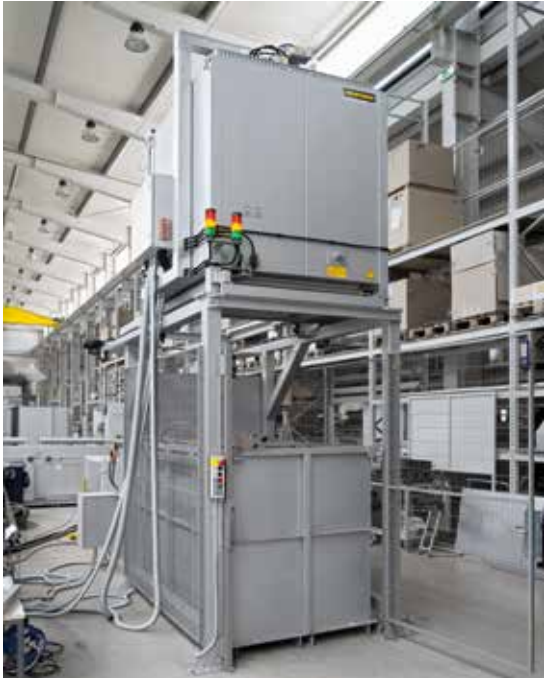
急冷浴槽が固定された投下型シャフト炉プラント (バリエーション A)
