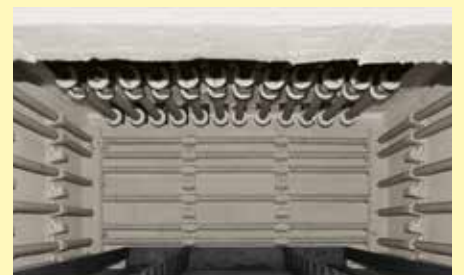
天井ヒーター付き炉室(余熱炉として使用の追加装備)
