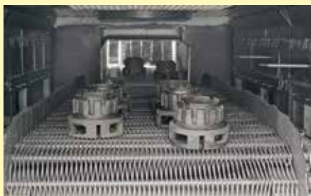
連続加熱炉内のエプロンコンベヤ駆動装置
