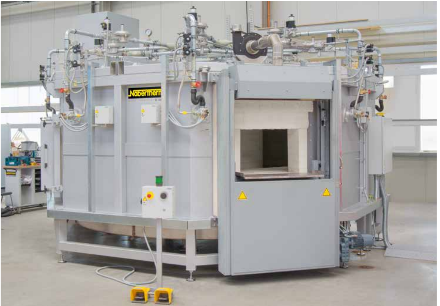
金型の予熱用の直接ガス加熱式回転炉床炉、最高温度 1100 °C
