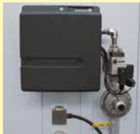
熱風循環式チャンバー炉 コンパクトなバーナーなどを使用するガス加熱式
