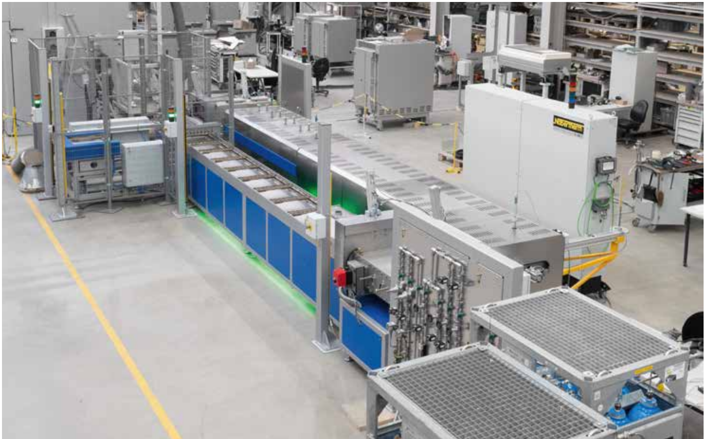
プッシャー式炉プラント D 520/2600/55-04、保護ガス下でのテフロンコーティングの焼結用
