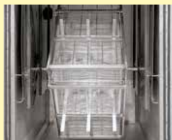
密封溶接された内室および充填用回転装置を装備したシリコーン用アニール炉
