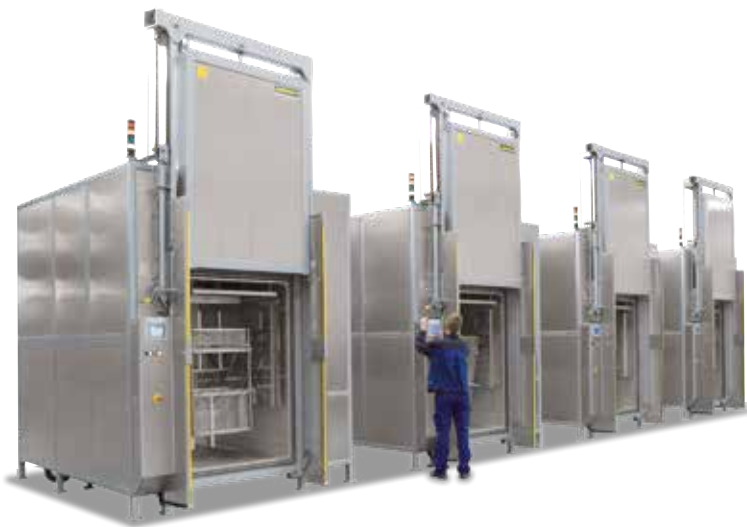
製造ユニット、熱処理中にワークを移動するための熱処理用チャンバー型乾燥機4台、エネルギー効率を最適化する三段階の熱交換器から成る。
