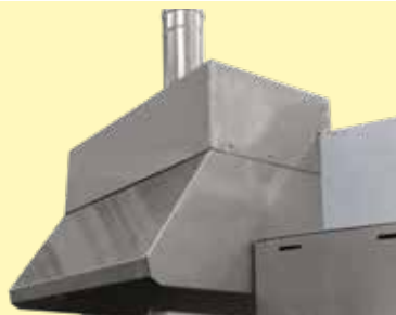
装入口上部に取り付けた排気フード
