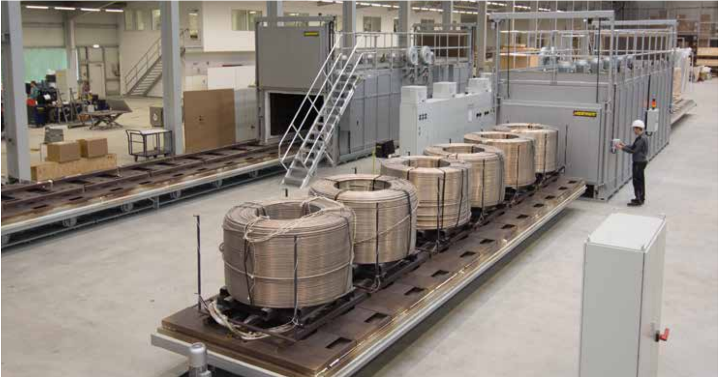
アルミニウムコイル熱処理用の熱風循環式台車炉 W 24750/60AS
