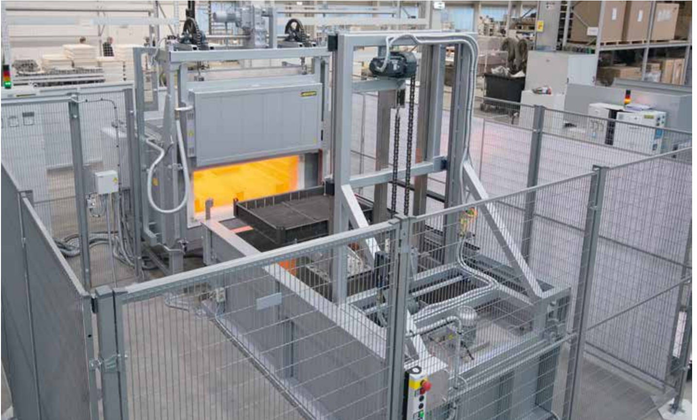
全自動焼入れ・焼戻しプラントは、焼鈍炉 1 基、水急冷浴槽 1 基、2 軸マニピュレーター 1 基で構成されます。
