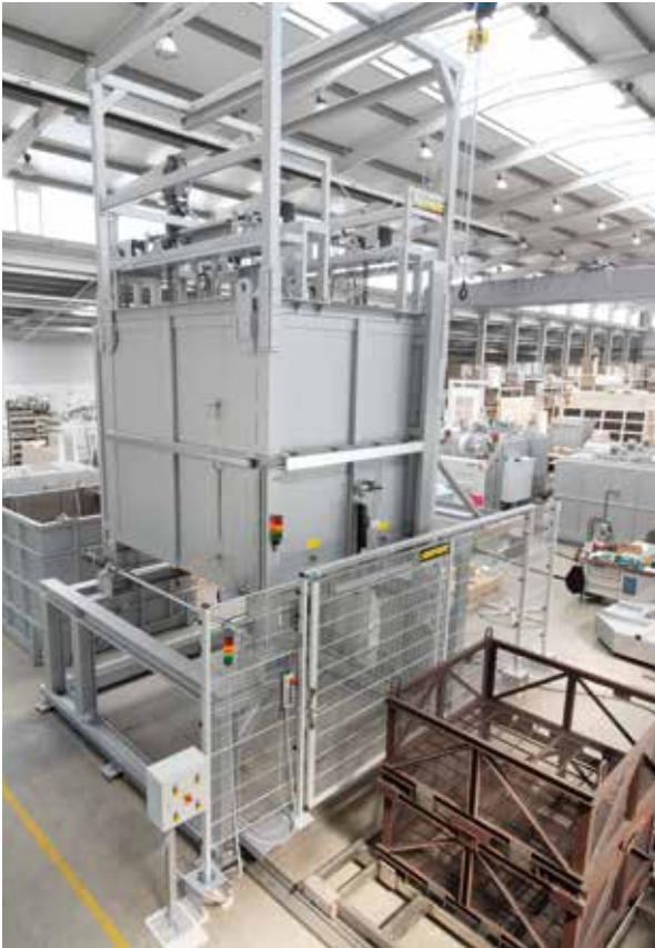
急冷浴槽が床に組み込まれている投下型シャフト炉 FS 5670/60AS (バリエーション C)
