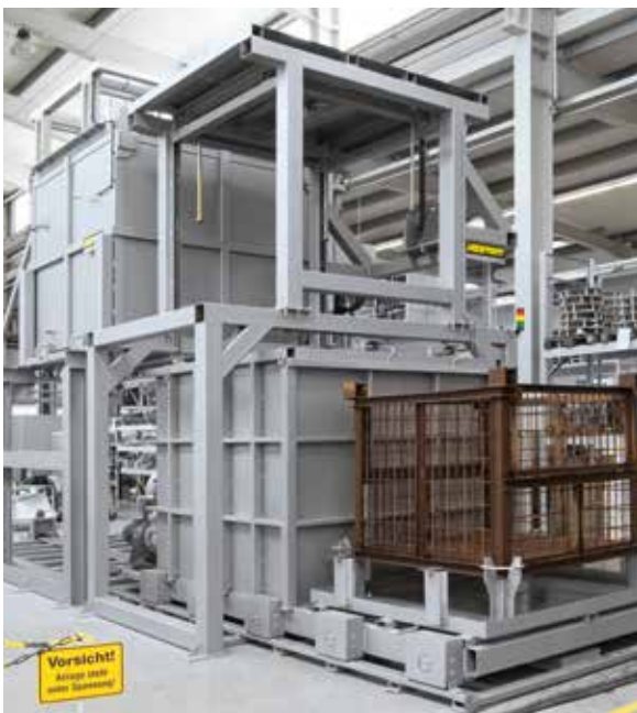
積み下ろしクレーンのある全自動投下型シャフト炉プラント (バリエーション B)
