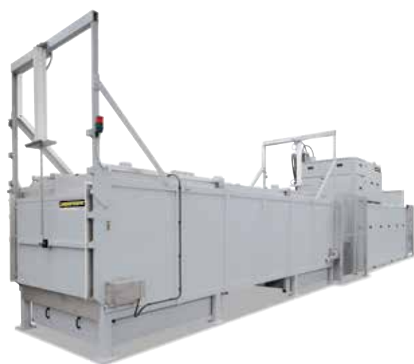
ホースの加硫用冷却ステーション KS 1600/6100/800/AS のある EN 1539 に準拠する連続炉プラント D 1600/6100/800/26AS
