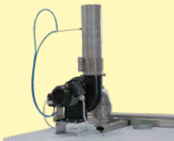
炉に取り付けられた空気取入れ開口部と高性能な排気ファン
