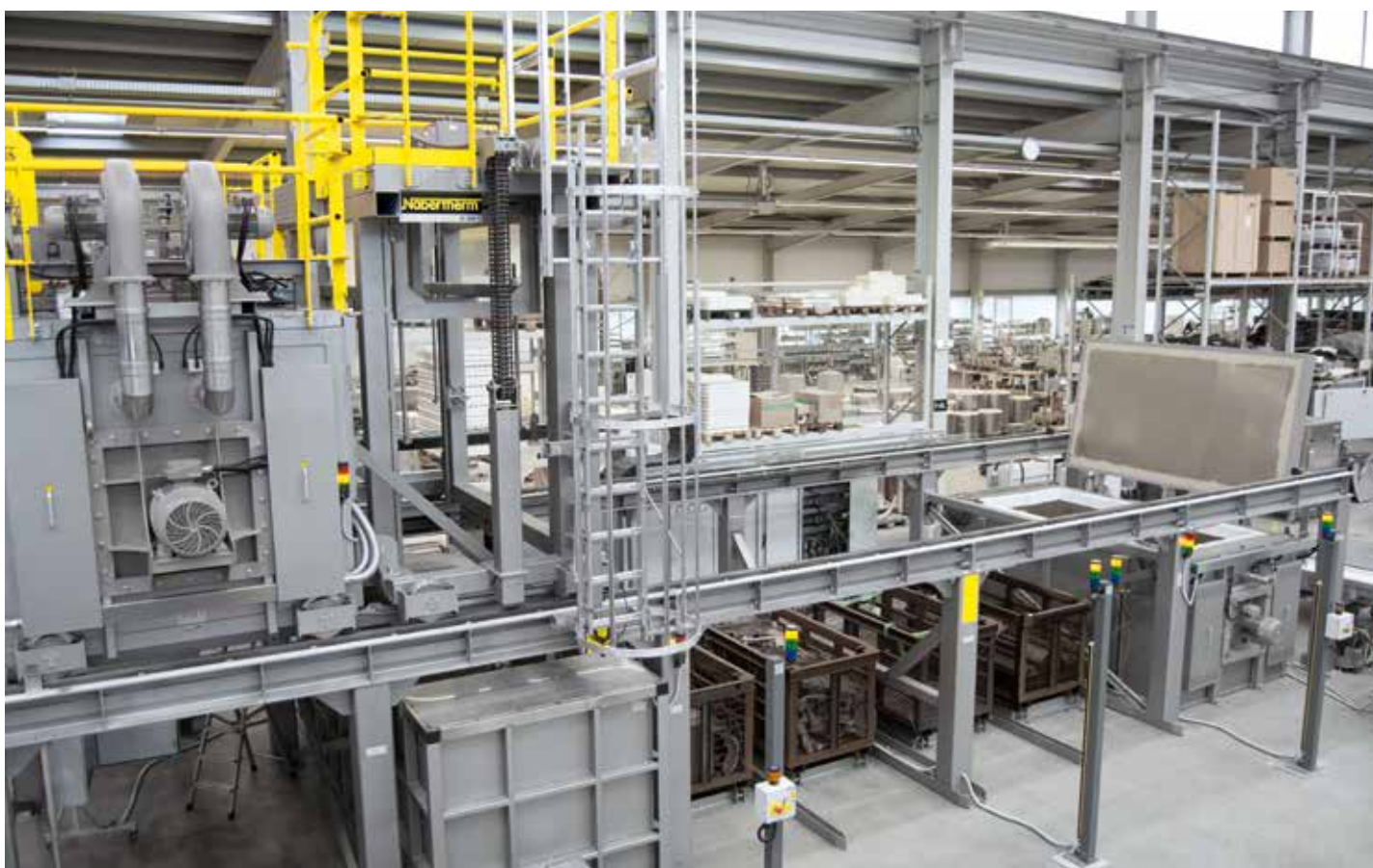
4つの停止位置がある人工時効用シャフト炉のある溶体化焼鈍用可動式投下型シャフト炉
