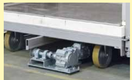
レール敷設不要の回転ラック駆動装置付きスチール台車
