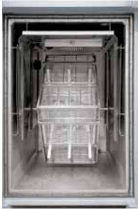
熱処理中に充填物を動かすバスケットを取り付けたモーター駆動の回転装置
