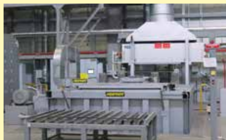
67,000 リットルの油が含まれる熱交換器のある油焼入れ槽 OAB 67000
