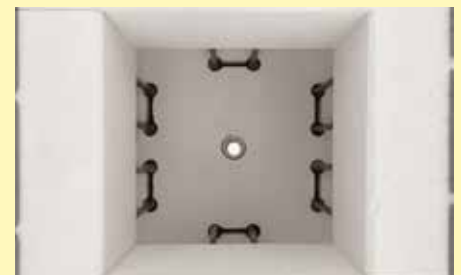
Muy buena uniformidad de temperatura gracias al calentamiento distribuido alrededor de la cámara del horno
