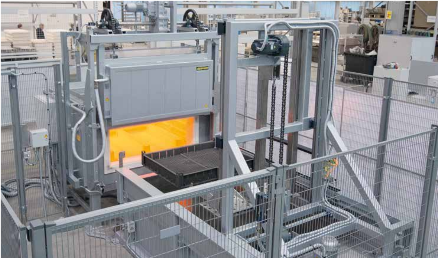
Automatische Abschreck- und Vergüteanlage N 644/S
