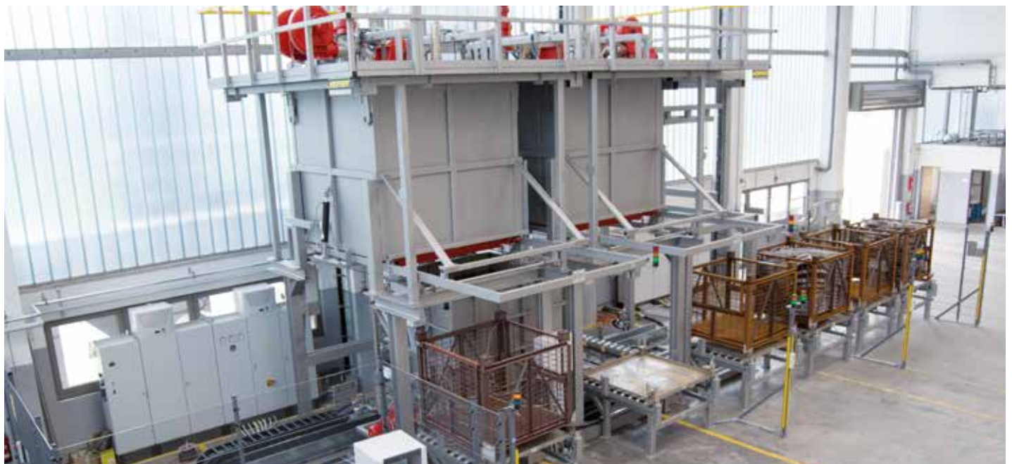
Vollautomatische Fallschachtofenanlage, bestehend aus zwei Fallschachttöfen, verfahrbarem Wasserbad und mehreren Belade- und Entnahmeplätzen
