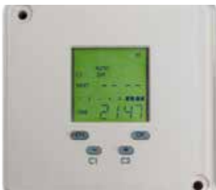
Wochenzeitschaltuhr zum Umschalten zwischen Schmelztemperatur und Absenkttemperatur
