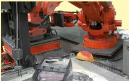
Entnahme aus einem Schöpföfen mit einem Schöpfroboter
