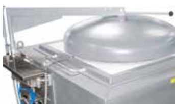
Schmelzbadregelung mit Thermoelement in der Schmelze
