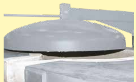
Schwenckdeckel mit guter Abdichtung zur Kragenplatte gegen Wärmeverluste über die Tiegelöffnung
