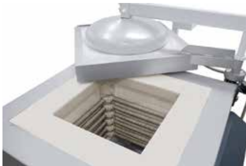
Kragenplatte eines elektrischen Tiegelofens schwenkbar zum Tiegelziehen
