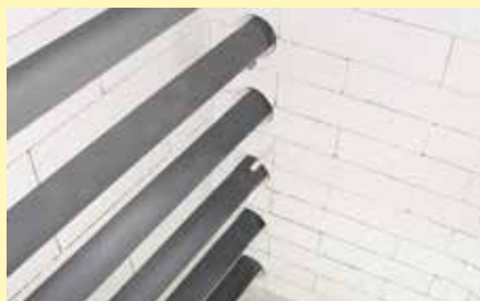
Beheizung von beiden Seiten über leistungsstarke SiC-Stäbe
