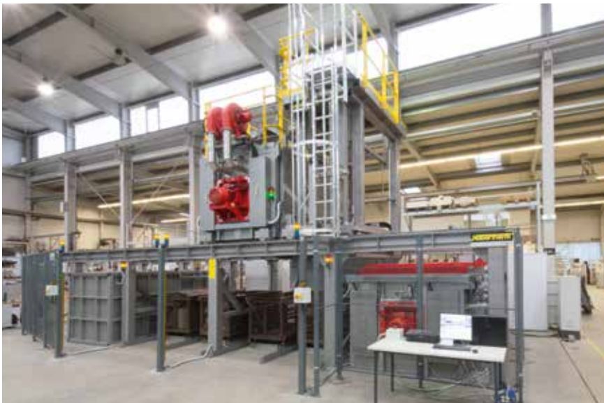
Verfahrbare Fallschachtofen zum Lösungsglühen mit Schachtofen zum Warmauslagern mit vier Stellplätzen
