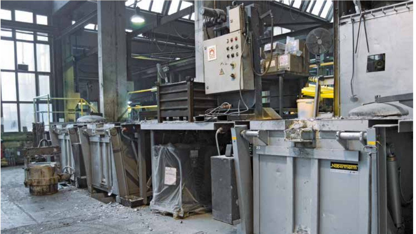
Drei Kippöfen mit Beschickungsplattform zum Schmelzen von Aluminium
