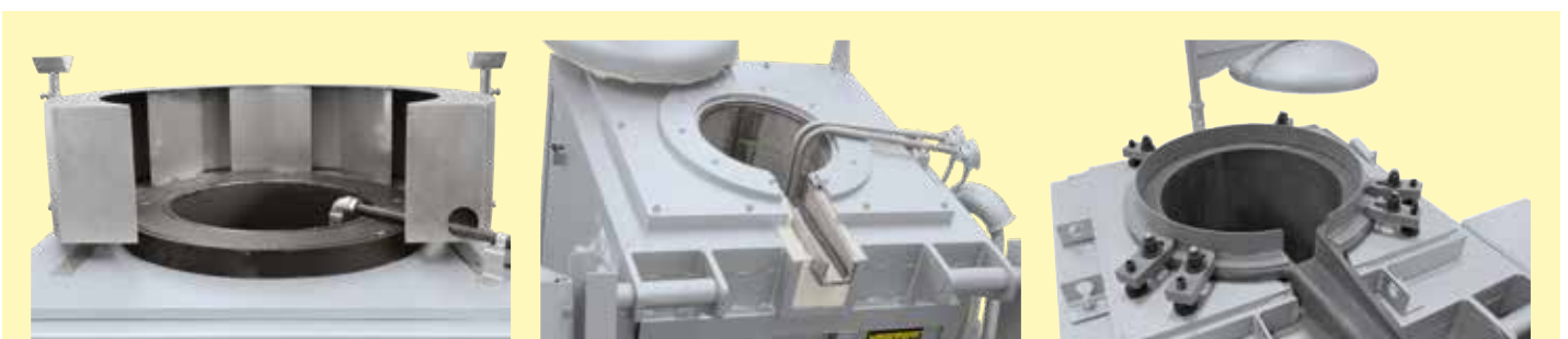
Randabsaugung zum Anschluss an kundenseitiges Abluftsystem
