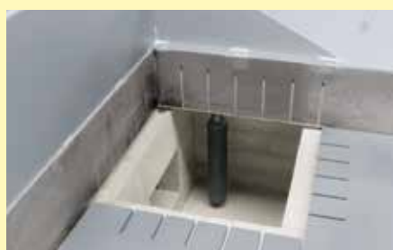
Schmelzbadthermoelement im Becken der Entnahmeöffnung
