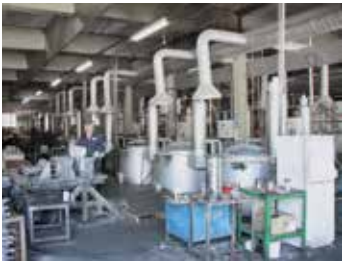
Rekuperator-Brenner an Aluminium-Schmelzöfen 16 x TBR 110/12 und 2 x TBR 180/12
