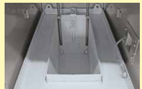
Salzbadtiegel aus hochwertigem CrNi-Stahl
