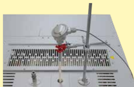
Thermoelement-Durchführung in der Decke mit Stativ
