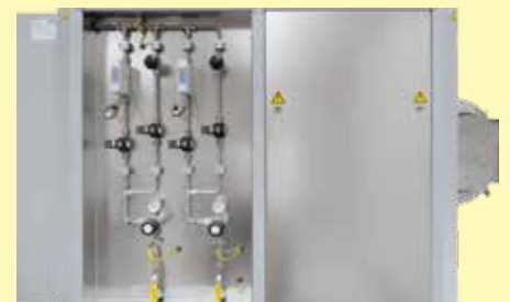
Begasungssystem mit Massendurchflussregler
