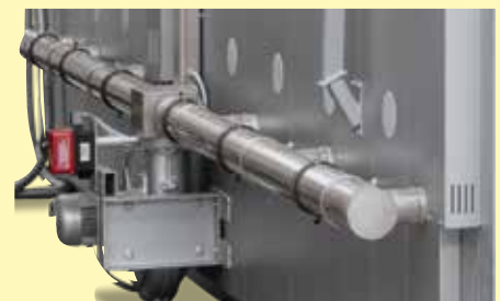
Kühlsystem mit Frischluftventilator
