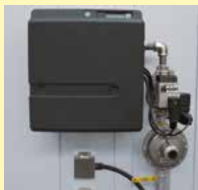
Umluft-Kammeröfen gasbeheizt z. B. mit Kompaktbrenner
