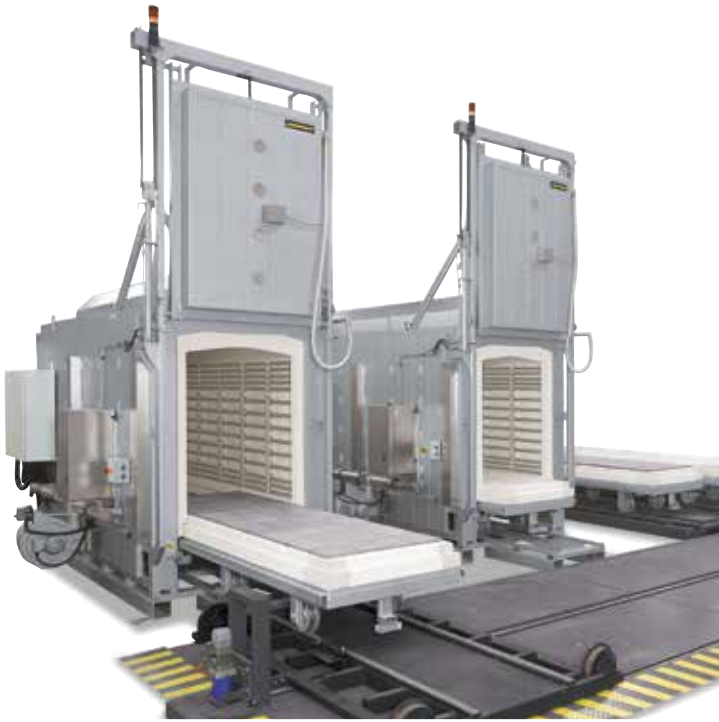
Kombiofenanlage, bestehend aus zwei Herdwagenöfen W 5000/H, Herdwagenverschiebesystem und zwei zusätzlichen Herdwagen inkl. der benötigten Abstellgleise
