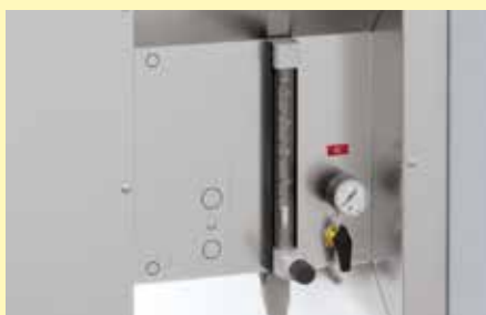
Automatisches Begasungssystem mit Magnetventil und Schwabekörper-Durchflussmengenmesser
