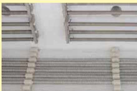
Faserisolierung für verkürzte Aufheizzeiten und Abkühlzeiten
