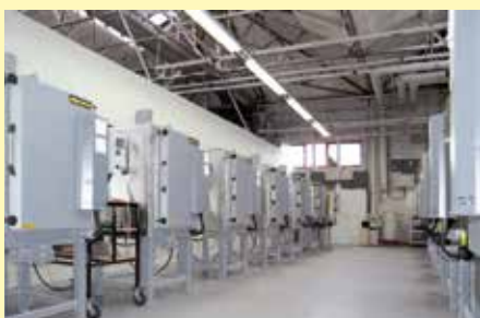
Kammeröfen N 200/14 zum Sintern von Halbleitern
