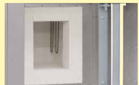
Feuerleichtsteinisolierung und Molybdän-Disilizid-Heizelemente
