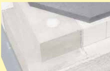
Thermoelementdurchführungen (Ø 40 mm) in den vorderen Ecken des Herdwagens
