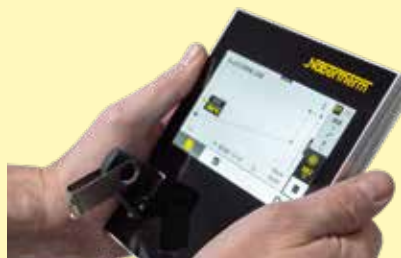
Aufzeichnung von Prozessdaten des angeschlossenen Controllern per USB-Stick
