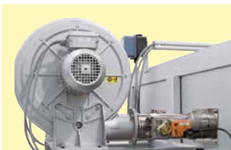
Kühlgebläse zum beschleunigten Abkühlen
