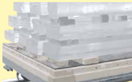
Herdwagenofen zum Tempern von Quarzgutstangen
