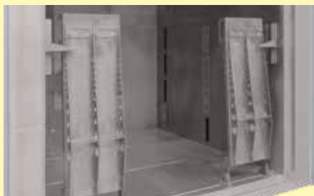
Einfahrrampen bei Öfen mit Bodenisolierung für Prozesse mit hohen Anforderungen an die Temperaturgleichmäßigkeit
