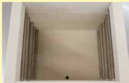
Gli elementi riscaldanti su tubi portanti favoriscono la libera dissipazione del calore
