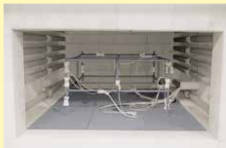
Struttura di misurazione in un forno di ricottura
